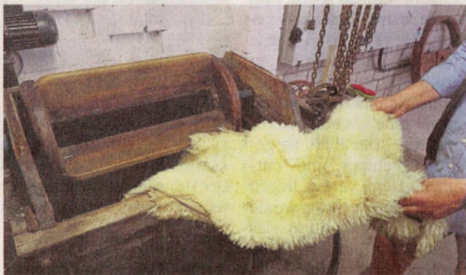
In dieser Haspel werden Schaffelle mit Salz und Säure sauergestellt und haltbar gemacht.
